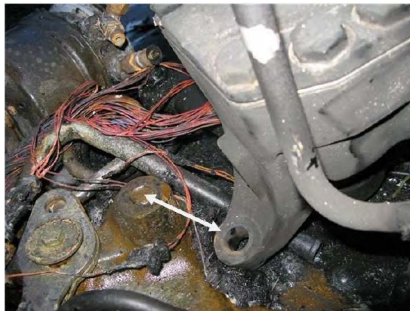
Figur 2: Viser at styresnekken har løsnet fra sine opprinnelige festepunkter i rammen. Foto: Statens vegvesen
