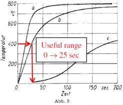
Zeitlicher Temperaturverlauf in der Stahlhülse bei Erhitzung mit vier Gasbrennern im Schutzkasten, gemessen mit Thermoelement: a) und b) Temperatur am Boden der Hülse; a) ohne, b) mit Sandfüllung; c) Temperatur 25 mm über dem Boden in Sandfüllung.
