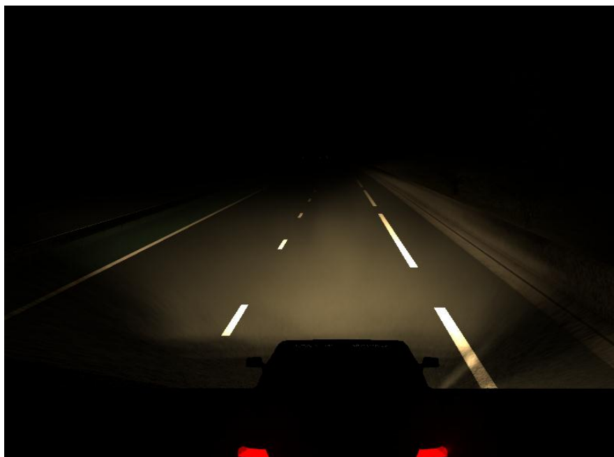
Рис. 3. Визуальная картина освещенности лучом ближнего света силой 140 лм в зоне I
