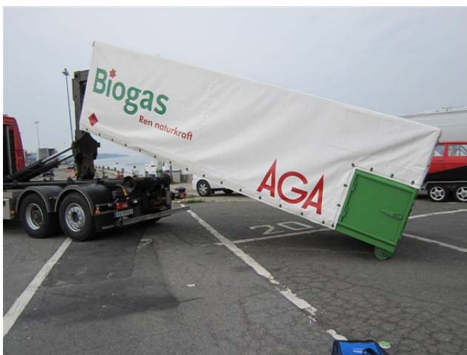
Разгрузка МЭГК с грузового автомобиля с помощью крюкового захвата
