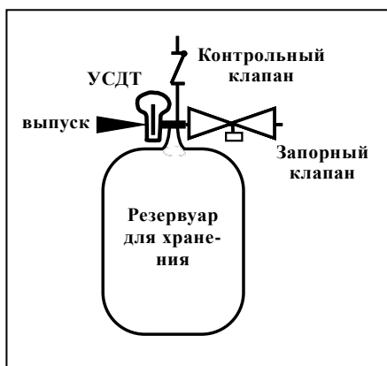
Рис. 1 Типичная система хранения компримированного водорода
