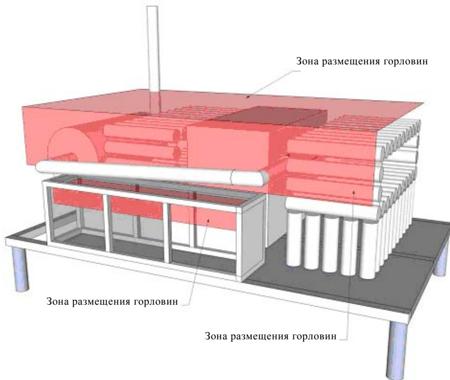
Рис. 11 Позиционирование горловин (вид сзади испытательного устройства)
