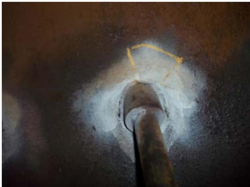
Штуцер 2 – это соединение для наполнения цистерны (он соединен с внутренним трубопроводом наполнения), и сварной шов его врезки имеет трещину длиной 90 мм, как показано ниже:
