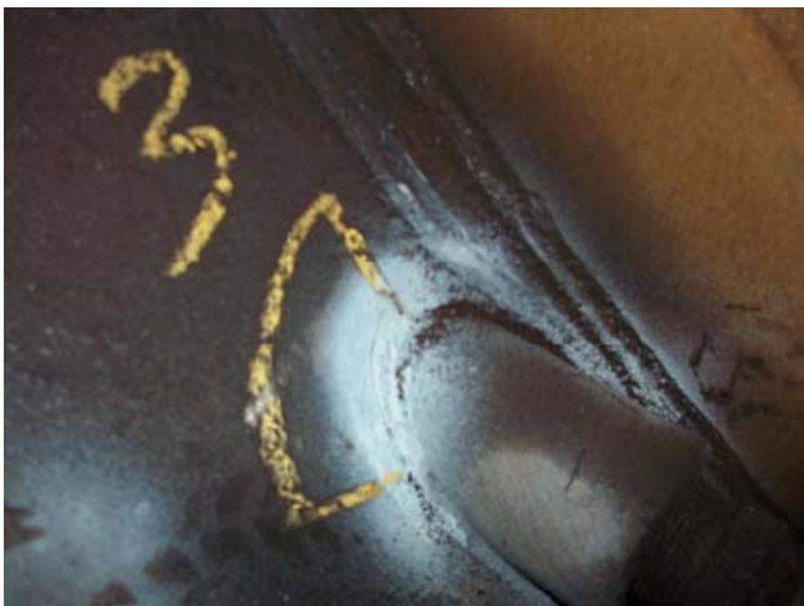
Магнитно-порошковая дефектоскопия сварного шва (проведенная в 1995 году одной из компаний в рамках ее процедуры контроля при покупке уже бывшей в эксплуатации встроенной цистерны, которая была изготовлена в 1973 году производителем цистерн, обладающим солидной репутацией) вокруг части основного выпускного штуцера позволила обнаружить, что отсутствовал внутренний корневой сварной шов и имелся лишь верхний сварной шов.
