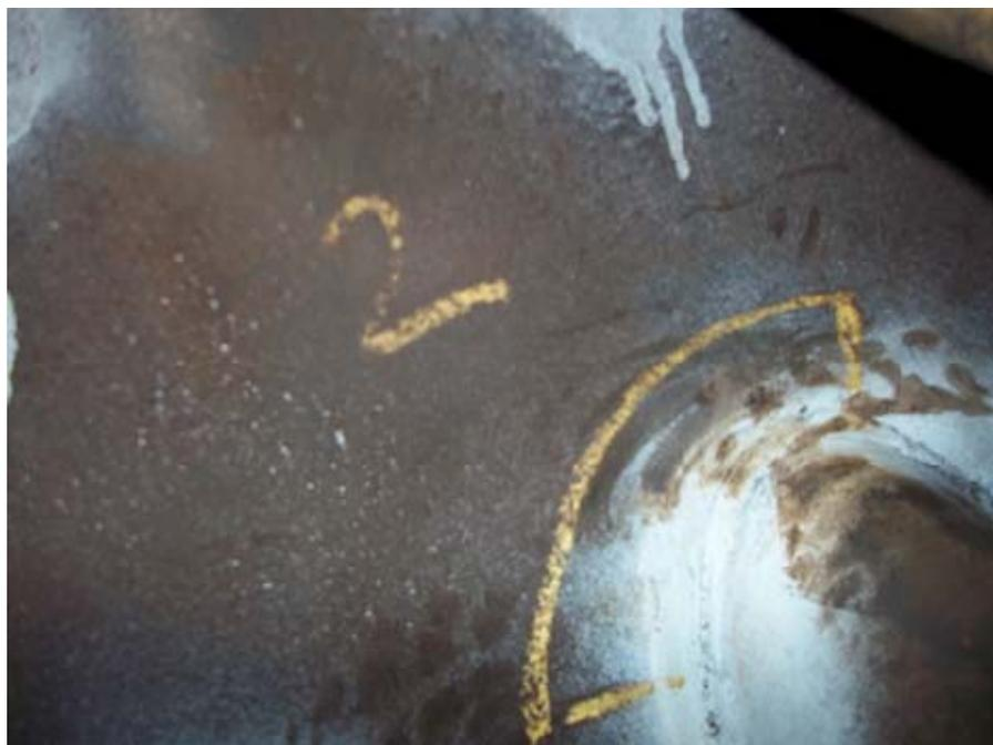
Штуцер 3 – это газоуравнительное соединение цистерны (он также соединен с внутренним трубопроводом), и сварной шов его врезки имеет трещину длиной 50 мм, как показано ниже:
