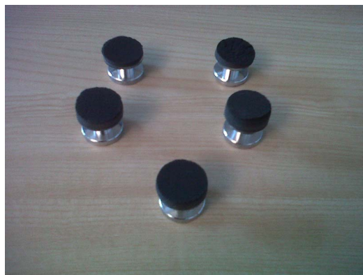
Пример испытательных плиток с вырванным слоем полиуретанового материала (испытание на адгезию)
