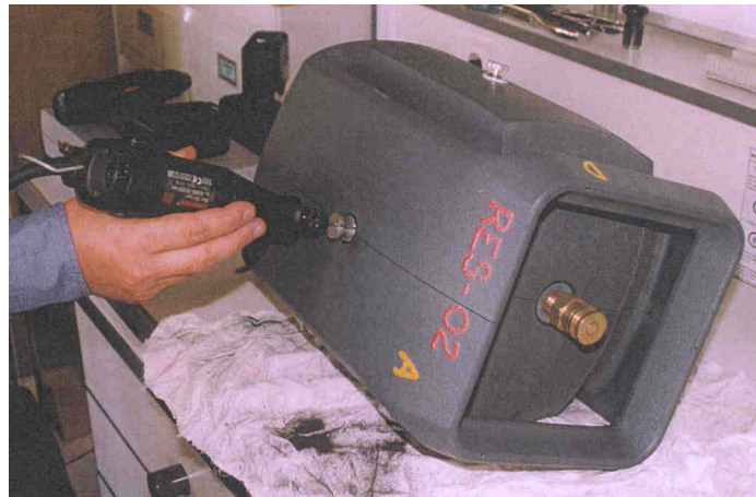
Пример испытания на адгезию
