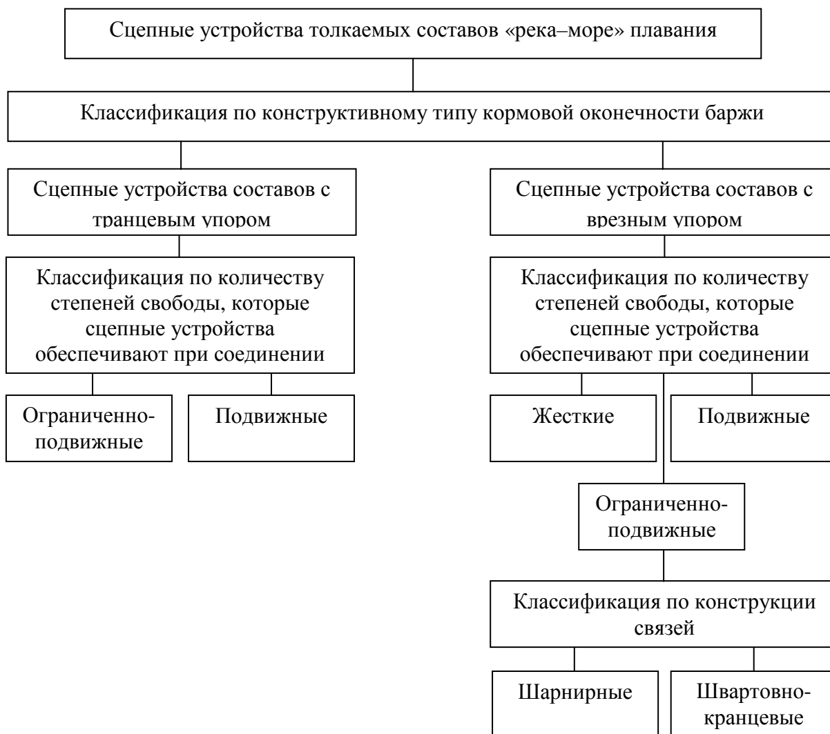
Рис. 3. Схема классификации сцепных устройств толкаемых составов
