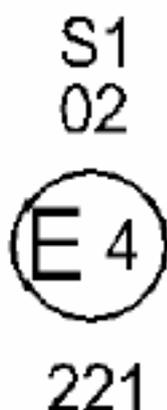
Le dispositif portant la marque d'homologation ci-dessus est un feu stop à ~~un niveau~~ **d'intensité lumineuse constante** homologué aux Pays-Bas (E4) sous le numéro d'homologation 221 en application du Règlement No 7.
