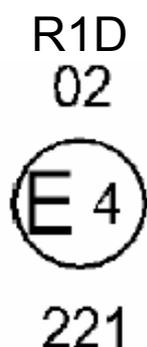
Le dispositif portant la marque d'homologation ci-dessus est un feu de position arrière **à intensité lumineuse constante** homologué aux Pays-Bas (E4) sous le numéro d'homologation 221 en application du Règlement No 7, qui peut aussi être utilisé dans un ensemble de deux feux-position arrière.
