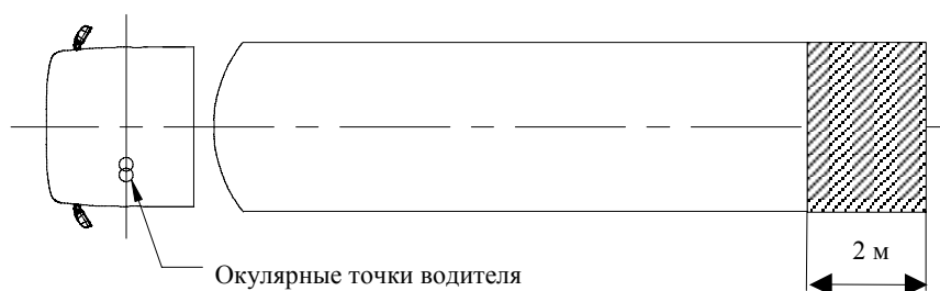
Рис. 9: Поле обзора задних устройств непрямого обзора
