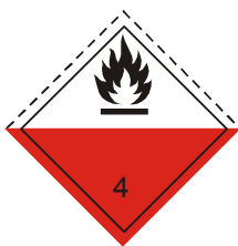
(№ 4.2) Подкласс 4.2 Вещества, способные к самовозгоранию Символ (пламя): черный; фон: верхняя половина белая, нижняя – красная; цифра "4" в нижнем углу
