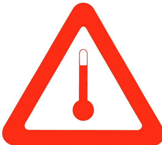
Рисунок 5.3.4 Маркировочный знак для перевозки при повышенной температуре
