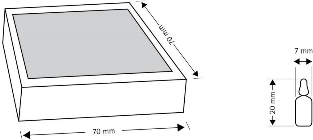
试剂工作溶液的制备方法是：掰去安瓿上部，将(装有产品的)下半部分放入规定数量的去离子水中。因此，无法对安瓿本身贴标签，因为标签可能污染工作溶液，进而影响后续反应。由于直接装载容器(即玻璃安瓿)的尺寸和形状，无法将所有适用的全球统一制度标签要素标于其上。
