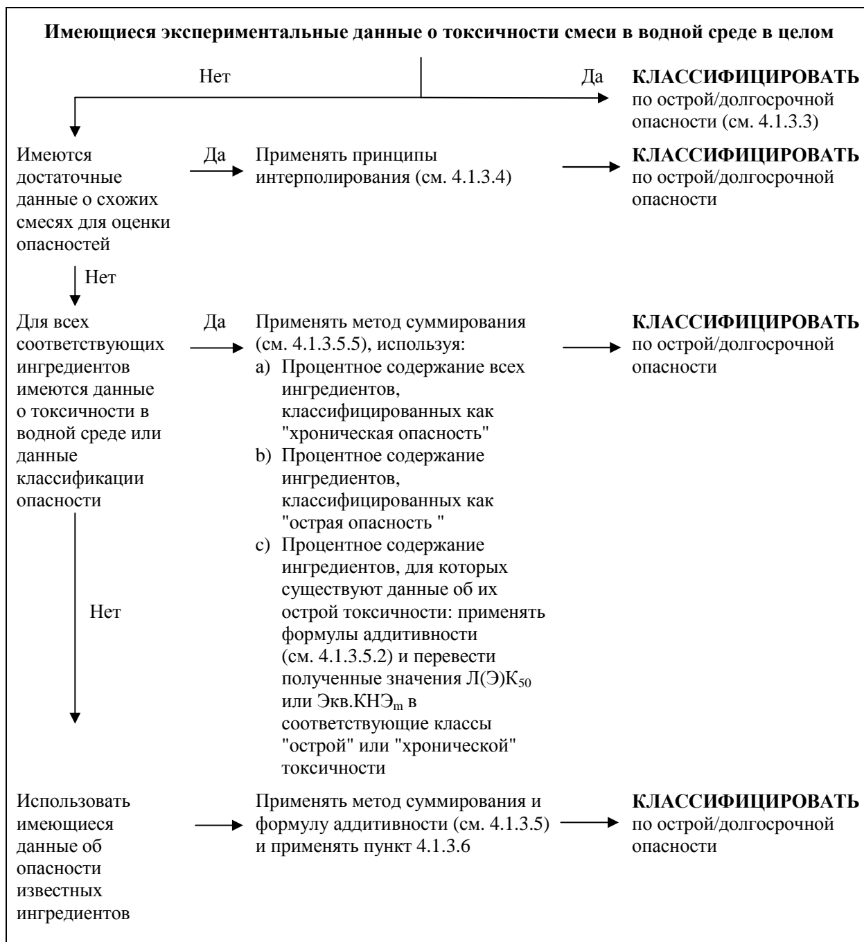
Рисунок 4.1.2: Логическая схема классификации смесей по острой и долгосрочной опасности в водной среде
