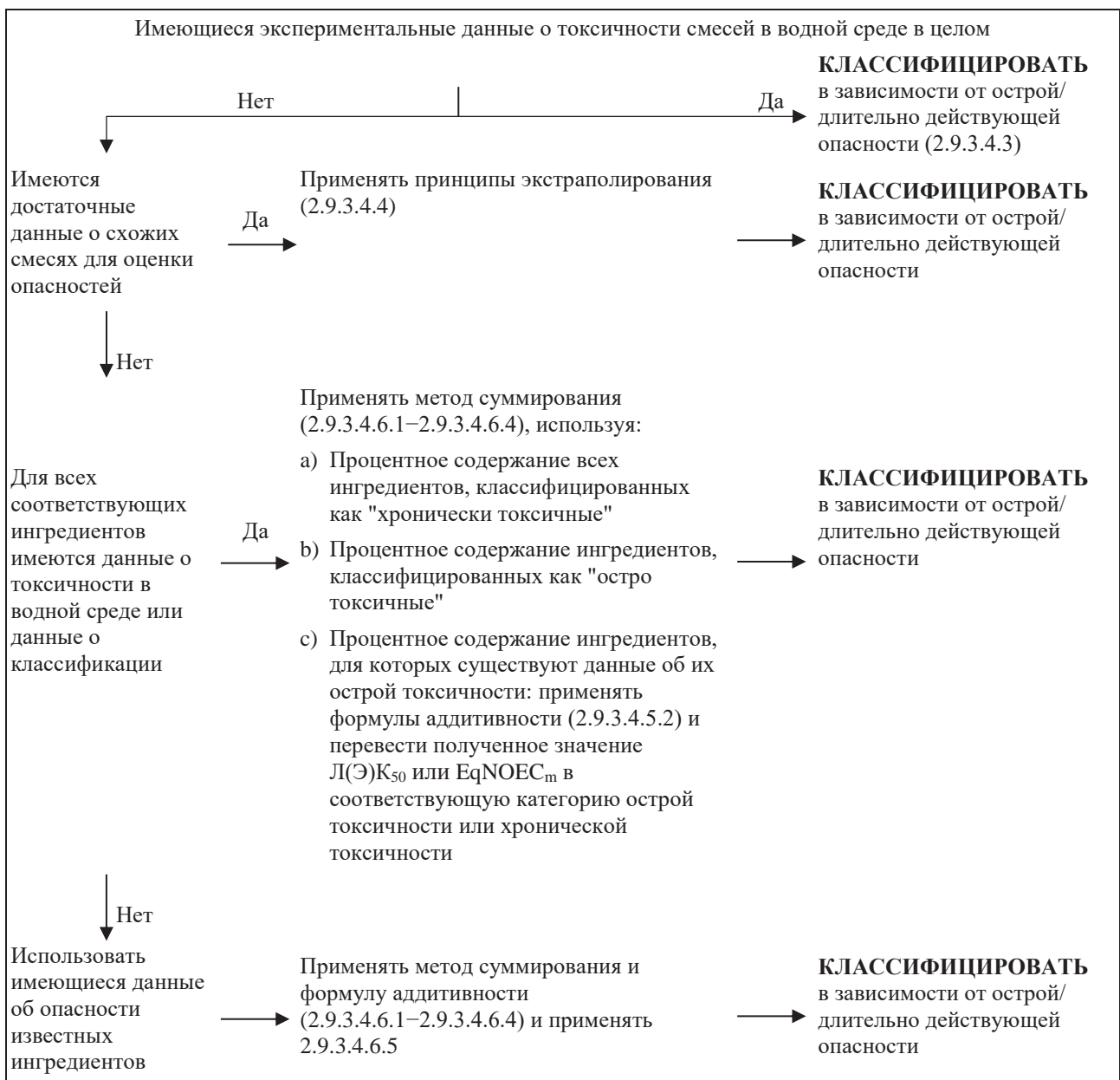
Рис. 2.9.2: Ярусный подход к классификации смесей в зависимости от их острой и длительно действующей опасности для водной среды
