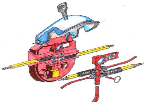
14. Les extrémités du câble sont fixées dans un logement spécial installé à l'arrière du compartiment de chargement. Des impulsions électriques sont sans arrêt envoyées dans le câble. Si celui-ci est endommagé ou coupé, l'impulsion lumineuse n'est plus reçue par le senseur optique de l'unité électronique qui déclenche immédiatement l'alarme auprès du centre de surveillance.
