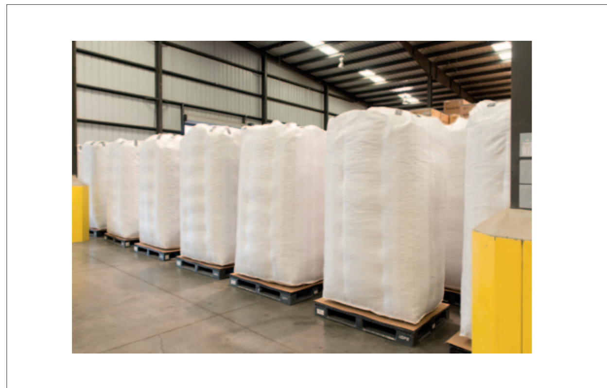
25 Conditionnement : exemple de conditionnement en super sacs d'un poids net de 910 kg
