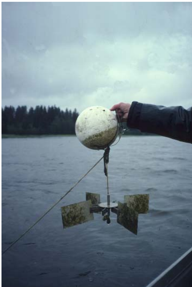
Рис. 18. Прибор для культивирования обрастаний, используемых в оценке развития перифитона в озерах (фото Сирпа Херве)
