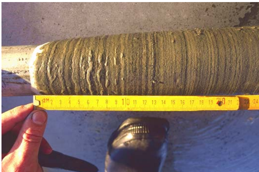
Рис. 24. Проба отложений, отобранная с помощью грунтовой трубки. На этой пробе легко различимы различные слои (фото Сеппо Кнууттила)
