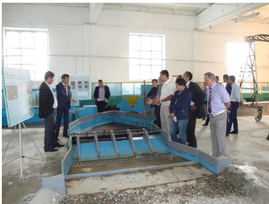
Рисунок 15 - Режим работы водозаборного гидроузла отражает гидравлическая модель
