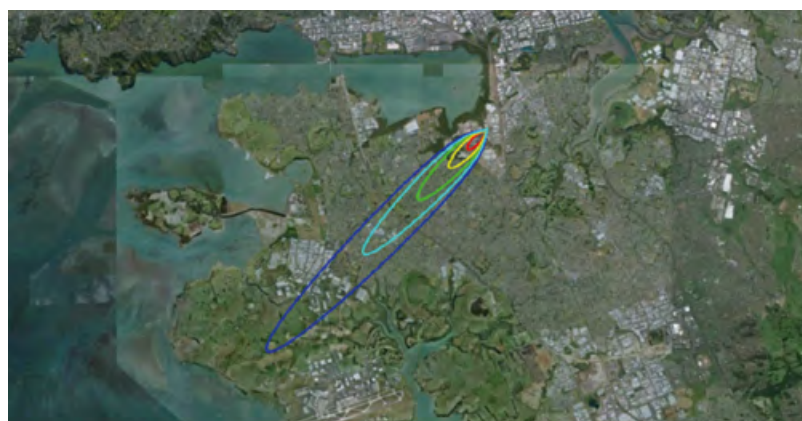
Figure 1 - Exemple de rejet continu de chlore
