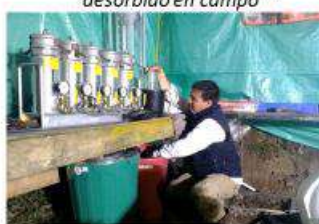
d. Medición gas perdido y desorbido en campo
