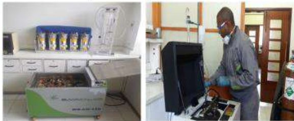
e. Mediciones de gas desorbido y residual en laboratorio
